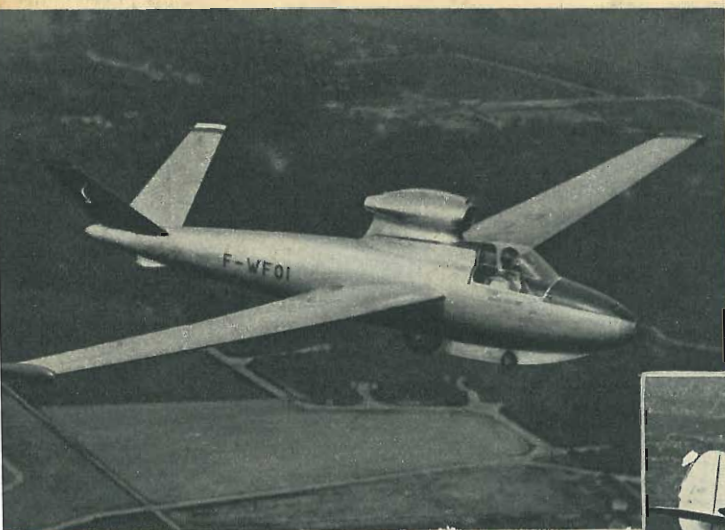
A sinistra: il primo esempio di aereo da turismo e sport, a reazione: il « Fougas C. M. 8 R. 13 azionato da un piccolo turboreattore Turbomeca Silphe che dà 150 chilogrammi di spinta. Sotto: un tipico apparecchio sportivo francese, il Sipa 900, dotato di motore da 75 HP e carrello fisso.
